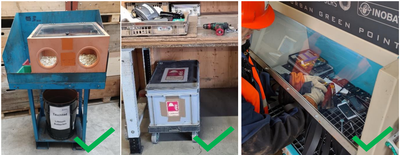
Exemples d'aménagement d'emplacements de démontage spéciaux pour les BLI avec: outils adéquats, dispositifs de stockage intermédiaires, récipients à portée de main pour isoler les BLI suspects ou dangereuses, ou hotte d'extraction. Photos: Altola AG (à gauche), DOCK Basel (au centre) et Solenthaler Recycling (à droite).
