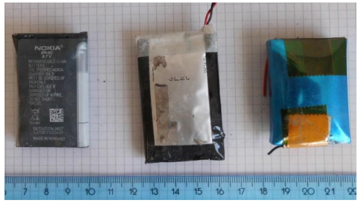
Ci-dessus: Exemple de cellules « Pouch » (batteries lithium-ion) endommagées ou gonflées. Photos: Solenthaler Recycling.
