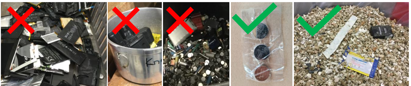
Gare aux courts-circuits! Éviter tout contact entre les pôles des batteries ou entre les batteries et d'autres éléments métalliques, y compris lors du stockage intermédiaire. Utiliser p. ex. de la vermiculite. En présence de nombreuses piles-boutons, les recouvrir en outre de ruban adhésif sur chaque face. Photos: Carbotech AG
